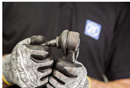
ZF Services Lemförder – drążki układu kierowniczego. Przeguby kulowe znajdujące się na końcach drążków narażone są na uszkodzenie przy każdym najechaniu koła na próg zwalniający, krawężnik, wpadnięciu w dziurę lub na pobocze drogi.
