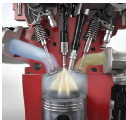
W głowicach silników z wtryskiem bezpośrednim jest bardzo ciasno, gdyż musi starczyć miejsca na wtryskiwacz benzyny.
