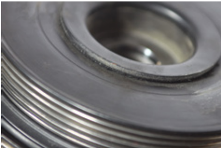
Odcisnięta śruba wału (fot. 1)
