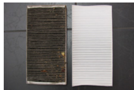
Zużyty filtra widać gołym okiem
