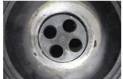
Wytarte powierzchnie wewnętrzne koła (fot. 7)
