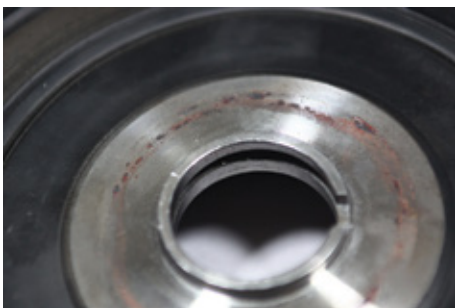
Odcisnięte koło wału, korozja (fot. 2)
