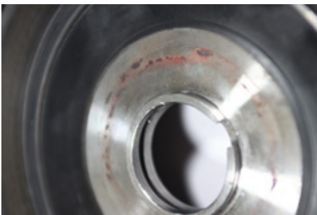
Nierównomierne zużycie, brak osiowości (fot. 3)
