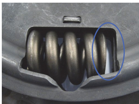
Konstrukcje współczesnych wielostopniowych tłumików drgań skrętnych w tarczach sprzęgłowych często wymagają luzu wstępnego.
