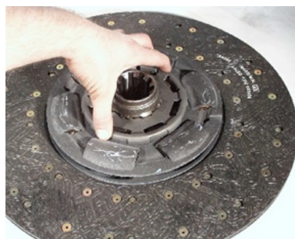
Konstrukcje współczesnych wielostopniowych tłumików drgań skrętnych w tarczach sprzęgłowych często wymagają luzu wstępnego.
