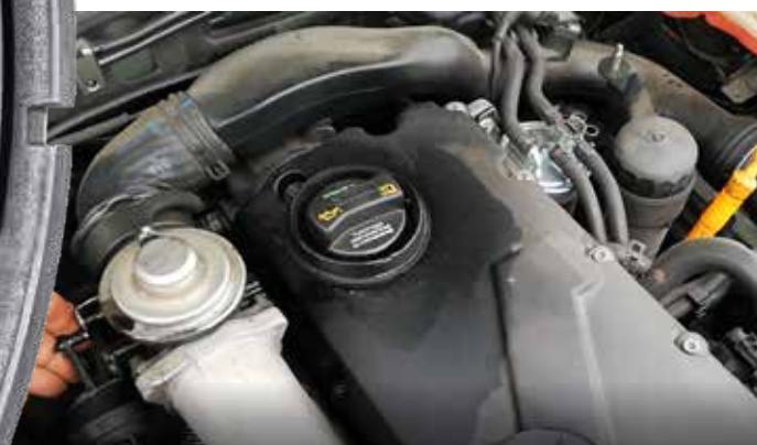
Foto 7: Ręcznie wystosowując przepustnicę weryfikujemy stuki podczas gaszenia silnika.
