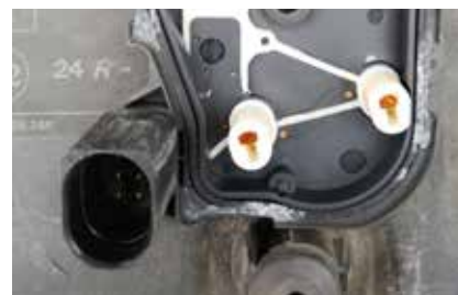
Foto 5: Wytarte ścieżki potencjometru.
