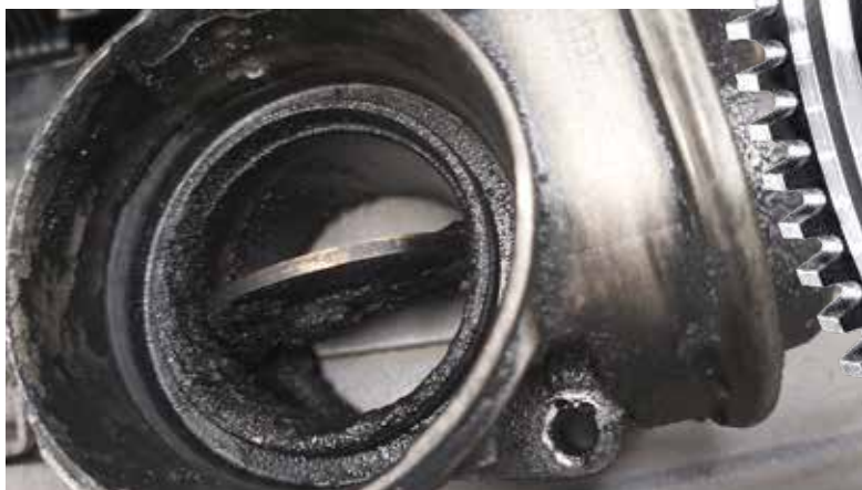
Foto 2: Uszkodzona przepustnica w Outlanderze.
