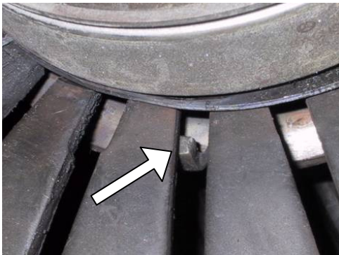
Rys. 1: Niewłaściwe osadzenie kołków prowadzących pierścienia wyciskowego – występ przesunął się pod sprężynę membranową
