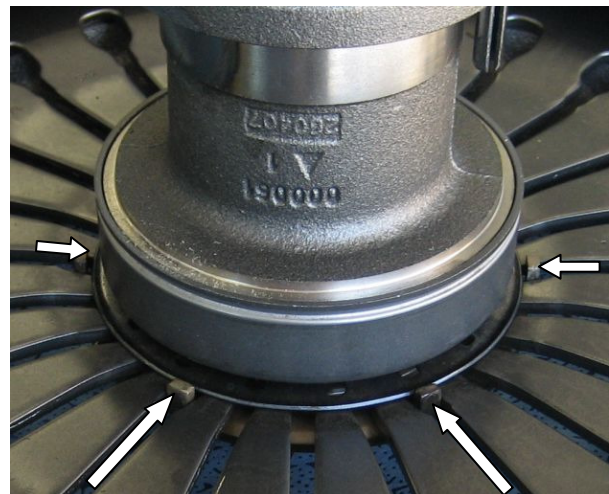
Rys. 3: występy prowadzące – widok z boku (widoczne są tylko cztery z łącznie sześciu występów kołnierza!)
